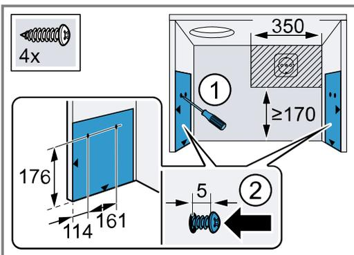
8. Die 4 beiliegenden Schrauben für die Haltewinkel bis auf 5 mm Abstand eindrehen.
